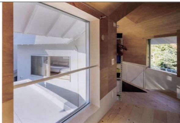
2階室C。左手の開口部越しに室Aを見返す。軒は50mm角鋼管の上に野地板、屋根材がのこ深い軒。
